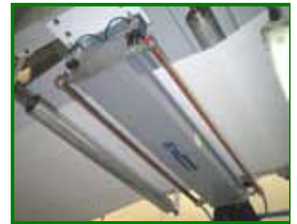
Web Cleaner DM 2000 en impresora flexo C.I.
