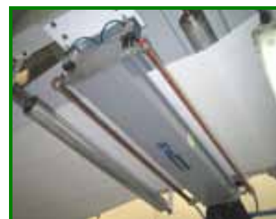
Web Cleaner DM 2000 su macchina flexo C.I.
